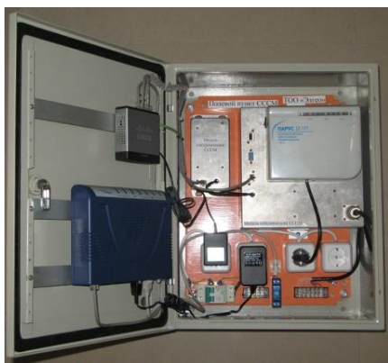
Рис. 7. Полевой пункт системы СССМ для подземной установки
