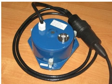
Рис. 4. Сейсмоприемник СССМ для поверхностной установки
