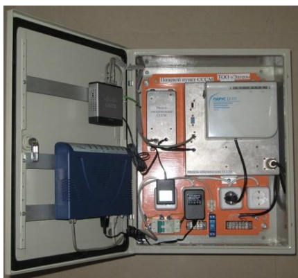
Рис. 7. Полевой пункт системы СССМ для подземной установки
