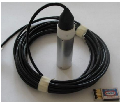
Рис. 5. Сейсмоприемник для скважинной установки
